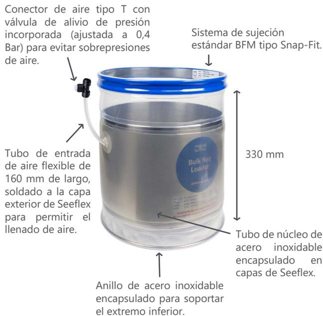
**IMPORTANTE:** Si se utiliza en zonas de polvo ATEX, las tuberías de línea ascendente y el tubo de entrada de aire deben conectarse a tierra.
